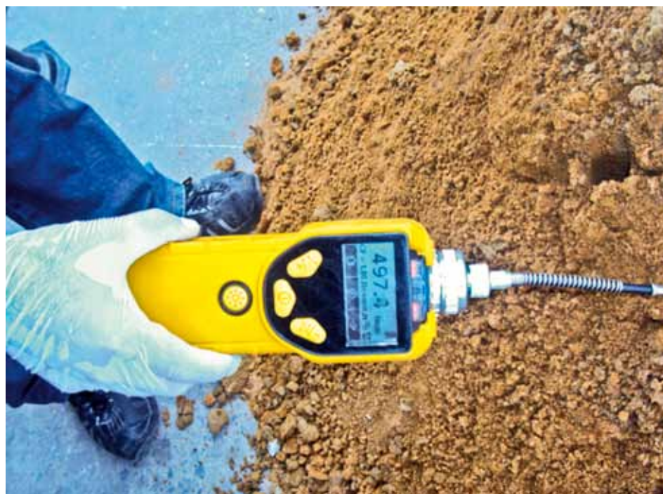
Figura 9.14: Detector acusando a presença de VOC na massa de solo escavado durante uma Investigação de Passivo Ambiental.
