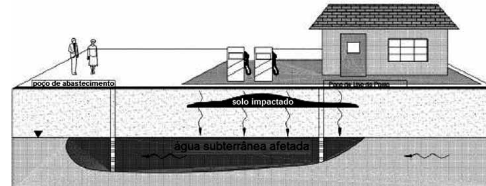
Figura 9.38: Ingestão de Água Subterrânea Contaminada a partir da Lixiviação do Solo Subsuperficial. Fonte: CETESB (2012).
