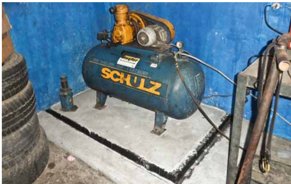
Figura 7.13: Compressor da borracharia em área impermeável circundado por canaletas. Fonte: Ministério Público/RN
