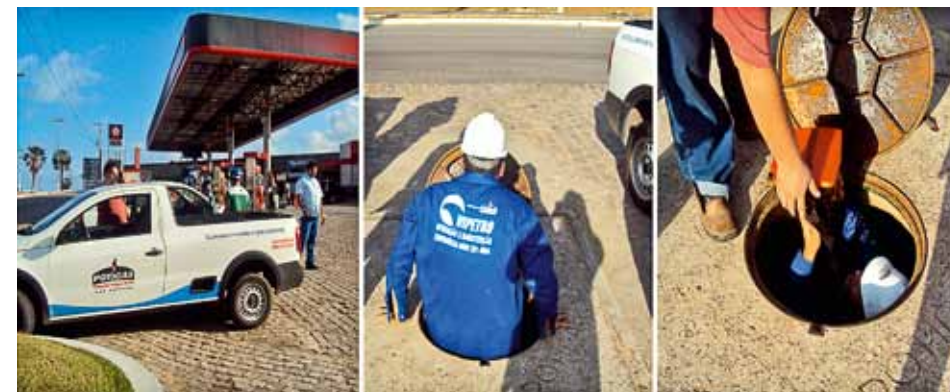
Figura 9.17: Avaliação do índice de explosividade nas galerias subterrâneas pela Potigás - Companhia Potiguar de Gás.
