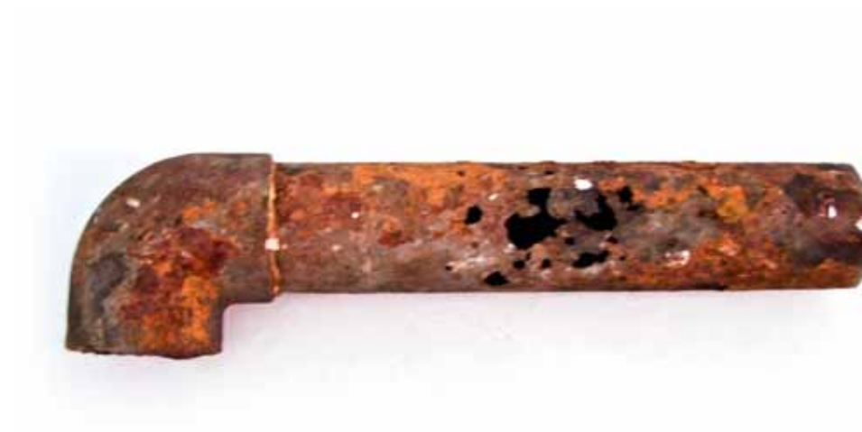
Figura 6.16: Tubulação metálicas corroídas e com furos causando vazamentos. Fonte: Ministério Público/RN
