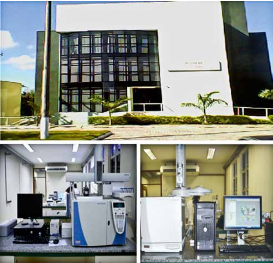
Figura 9.19: (A) Nupprar; (B) Cromatógrafo gasoso, Trace GC Ultra da Thermo Electron Corporation para análise de BTEX; (C) Cromatógrafo Gasoso, Focus GC da Thermo Electron Corporation para análise de HPA e TPH.
