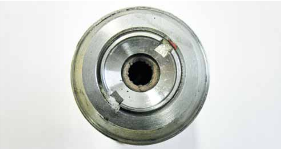
Figura 6.37: Estado de uma sede de válvula PSV instalada em um posto de GNV. Fonte: Ministério Público/RN
