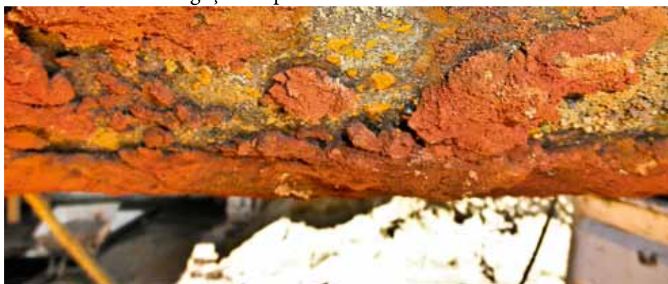
Figura 6.3: Grau de corrosão de um tanque simples (metálico) removido em 2009. Fonte: Ministério Público/RN
