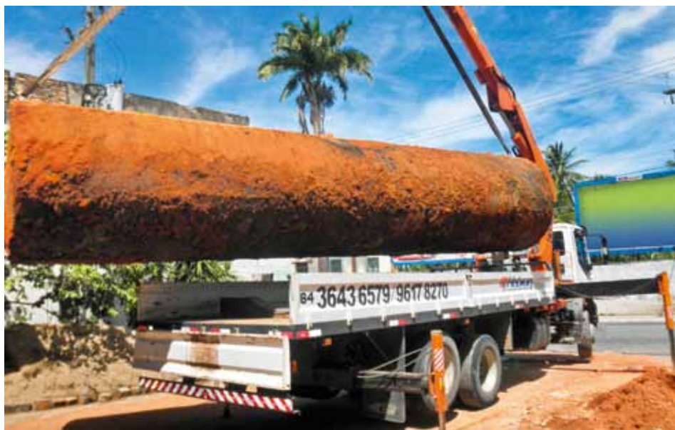
Figura 6.2: Grau de corrosão de um tanque simples (metálico) do tipo “charutão”. Fonte: Ministério Público/RN
