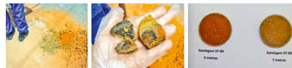
Figura 9.12: Diferença visual de solos contaminados por combustíveis (cor esverdeada) e solos limpos (cor avermelhada).
