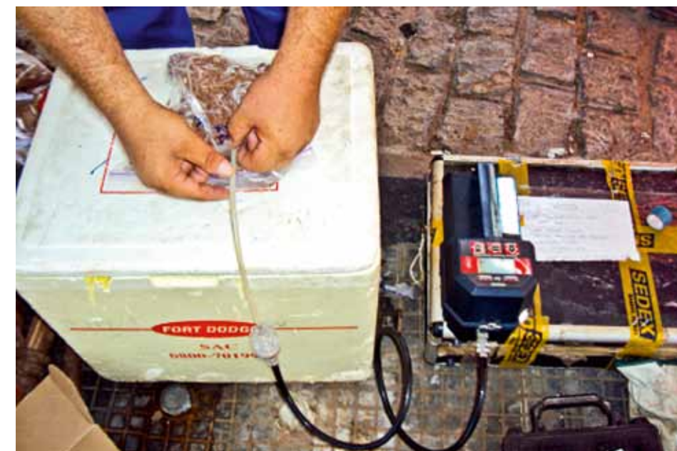
Figura 9.27: Análise de VOC em amostras de solo da cava de tanques removidos.
