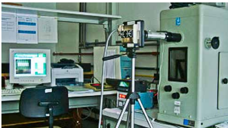
Figura 10.11: Calibração de blocos padrão pelo método interferométrico. Fonte: INMETRO.
