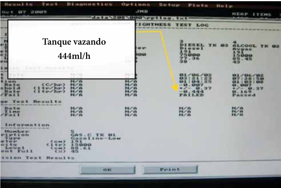
Figura 6.45: Resultado de um teste de estanqueidade em que foi detectado vazamento. Fonte: Ministério Público/RN
