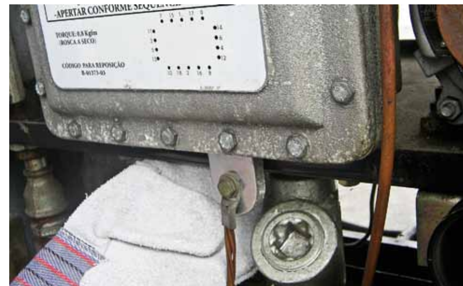
Figura 7.29: Aterramento correto da bomba de combustível. Fonte: Ministério Público/RN
