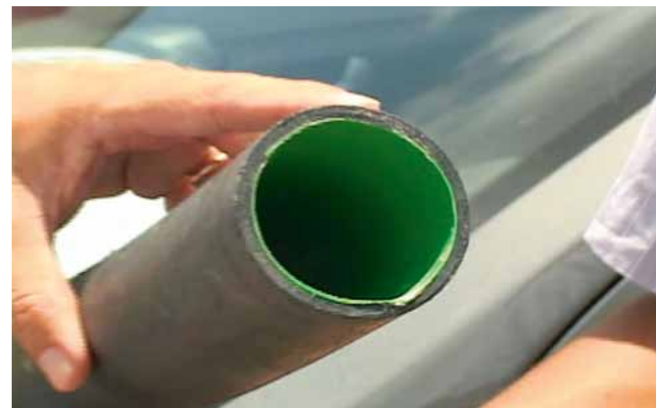
Figura 7.3: Tubulação não-metálica em PEAD que impede vazamentos. Fonte: Ministério Público/RN
