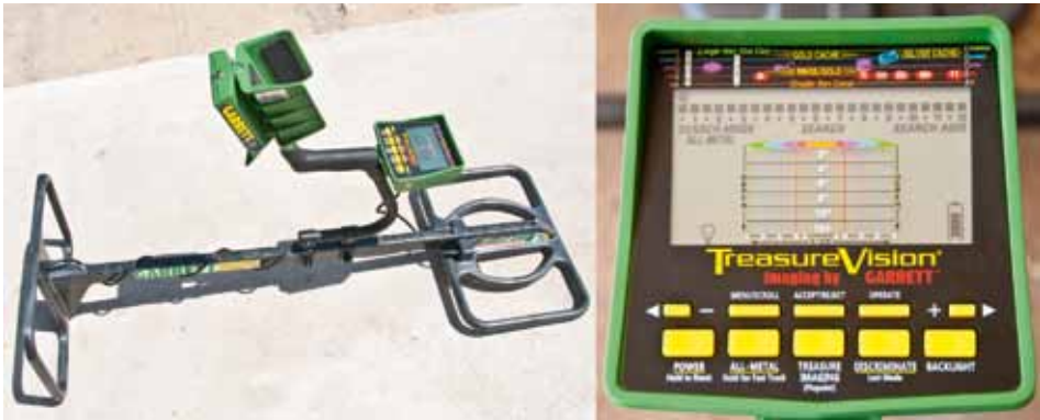
Figura 5.2: Display do equipamento indicador da presença de tanques. Fonte: Ministério Público/RN.
