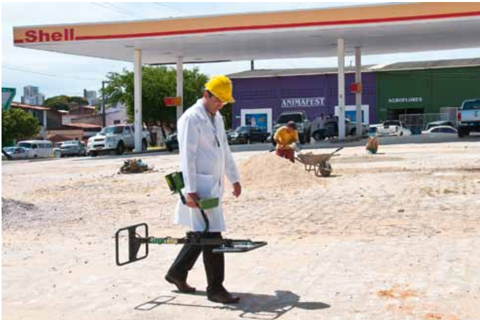
Figura 5.1: Foto dos peritos realizando o mapeamento de tanques soterrados. Fonte: Ministério Público/RN.
