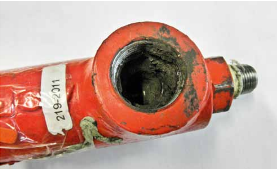
Figura 6.36: Incrustações obstruindo uma válvula PSV de uma instalação de GNV. Fonte: Ministério Público/RN
