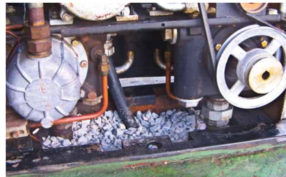
Figura 6.24: Uso incorreto de brita para fazer o papel de contenção ( sump ) na bomba. Fonte: Ministério Público/RN
