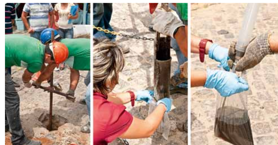
Figura 9.18: (A) Sondagem a trado; (B) Coleta de solo; (C) Coleta de água subterrânea com bailer.
