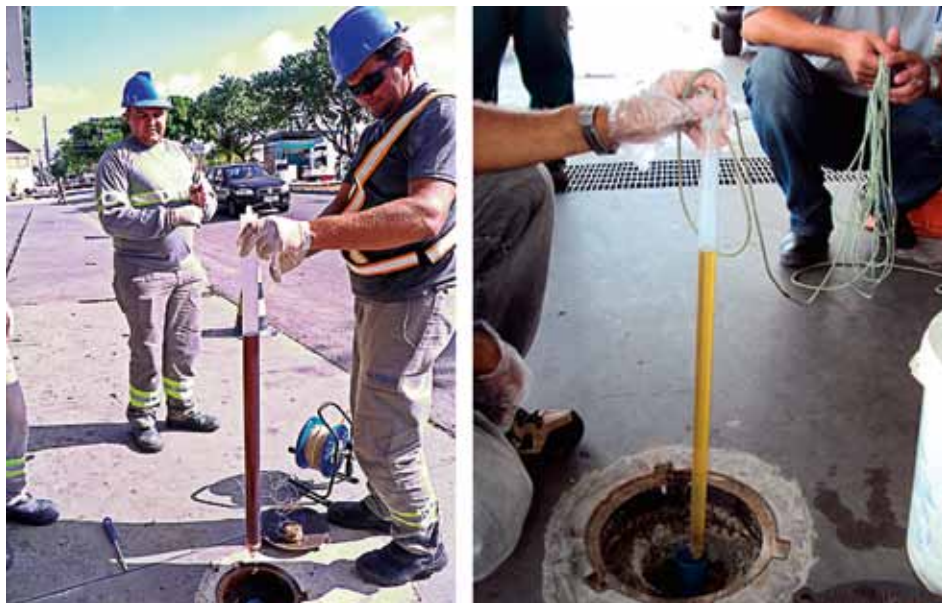
Figura 9.53: Presença de fase livre em poços de monitoramento de um posto revendedor de combustíveis.
