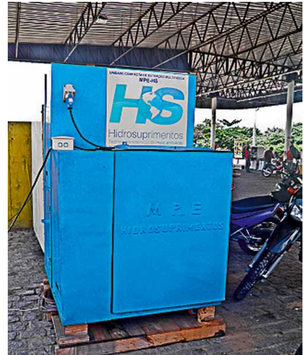
Figura 9.54: Sistema de extração multifásica para bombeamento de fase livre e remediação de águas subterrâneas e solos contaminados.
