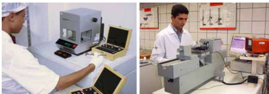
Figura 10.14: (A) Calibração de pesos (B) calibração de anel padrão.
