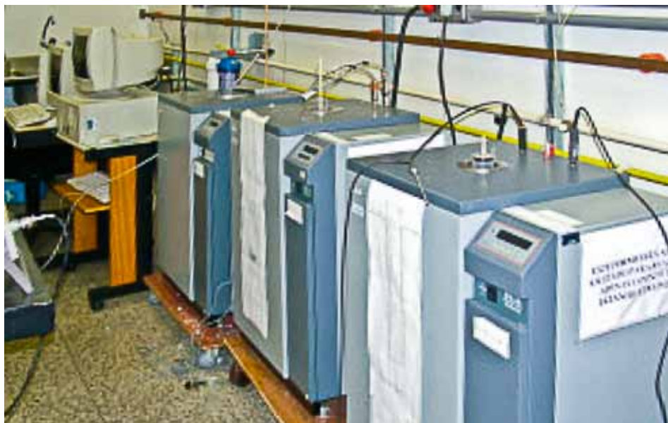
Figura 10.10: Calibrações de TPRP e termopares por pontos fixos. Fonte: INMETRO.
