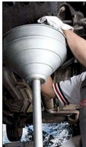
Método tradicional de retirada do óleo por ação da gravidade (escoamento pelo cárter)
