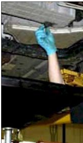
Método tradicional de retirada do óleo por ação da gravidade (escoamento pelo cárter)
